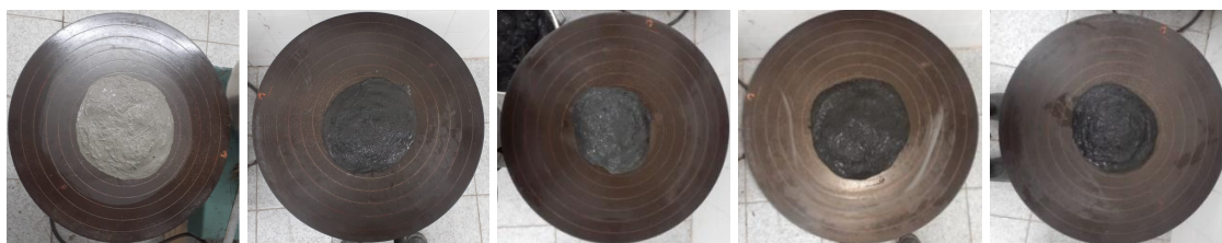
a) b) c) d) e) Figura 18 Ensaio de espalhamento: a) 0,3MK4%, b) 0,3CCA4%, c) 0,3CCA6%, d)0,5CCA4%, e) 0,5CCA6%
