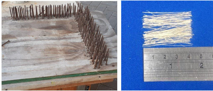
Figura 12 Alinhamento e corte das fibras. a) pente de pregos; b) fibras de sisal cortadas com 40mm de comprimento
