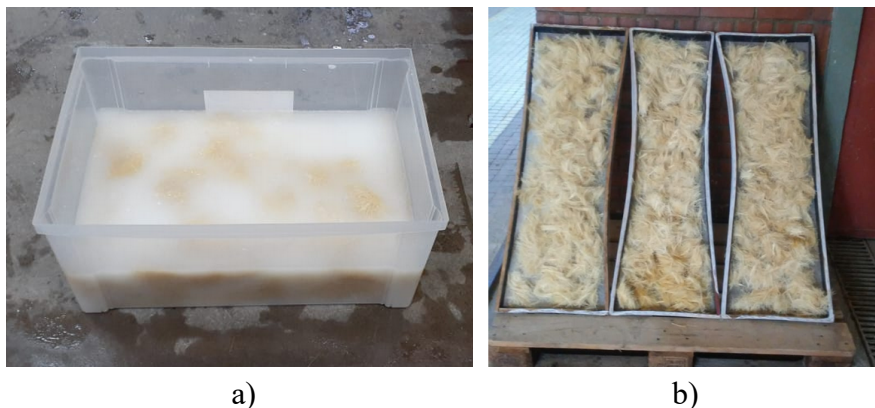
Figura 13 a) Lavagem alcalina das fibras de sisal; b) Secagem das fibras tratadas
