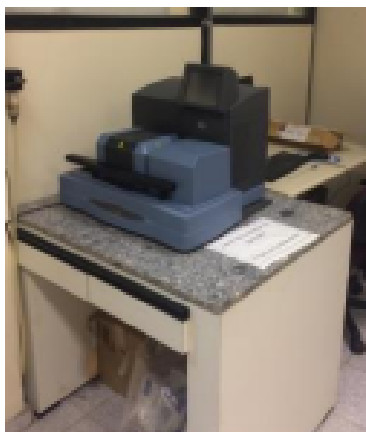
Figura 20 Equipamento SDT Q600 TGA/DTA/DSC Simultâneo da TA Instruments.
