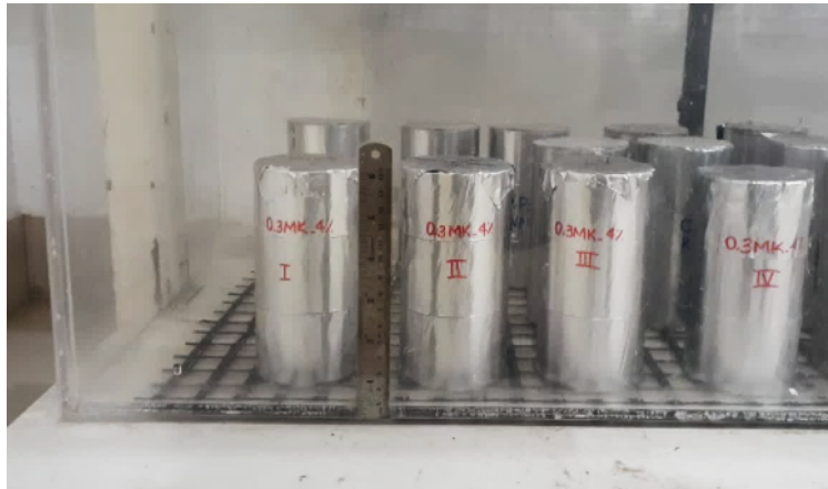
Figura 23 Corpo de prova selados em ensaio de absorção por capilaridade
