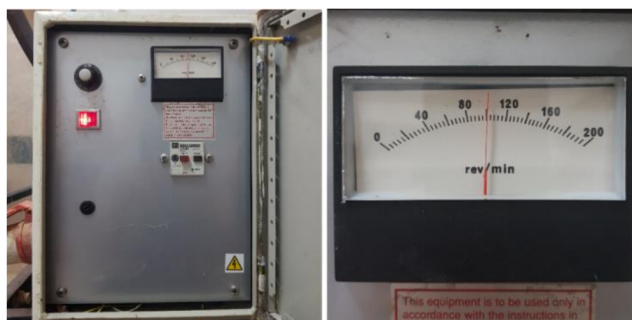
Figura 24 - Painel de controle e indicação da rotação (100 Rev./min).
