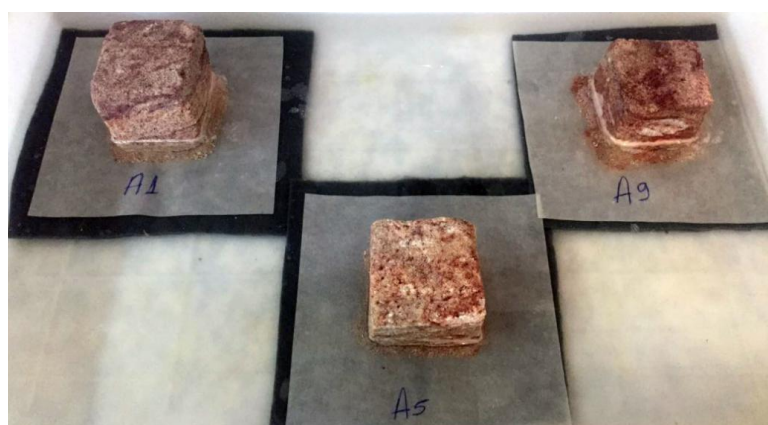
Figura 13 - Ensaio de desagregação, após o aumento do nível de água para 1/3.
