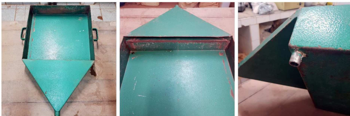
Figura 19 – Fôrma de moldagem do corpo de prova
