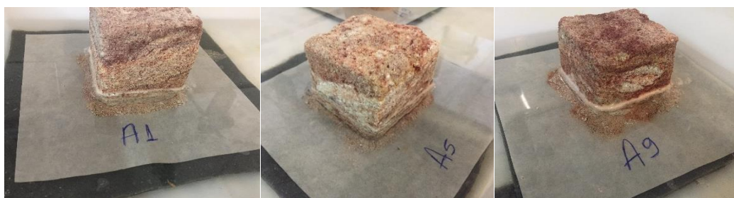
t = 15min – Água cobrindo 1/3 da altura das amostras de solo
