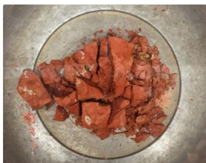
Figura 9 - Tentativa de moldar o corpo de prova da amostra do horizonte superior
