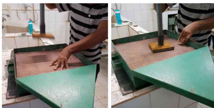
Figura 22 - Compactação do corpo de prova com auxílio de um soquete.
