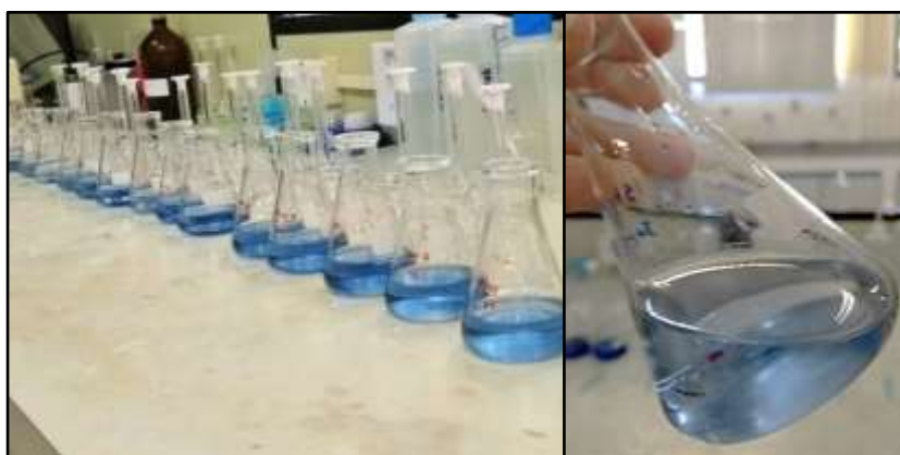
Figura 21: Análise da concentração final de fosfato pelo método do ácido ascórbico em espectrofotômetro UV-VIS.
