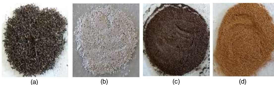
Figura 11: (a) lodo seco e macerado, (b) resíduo de concha de molusco, (c) mistura dos precursores a e b (peneirados a 80 mesh), (d) Material calcinado (MAD10).
