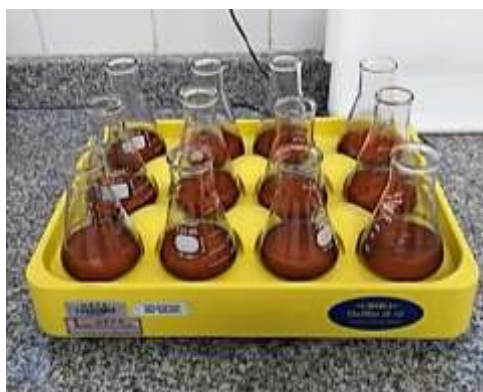
Figura 20: Ensaio do estudo cinético de adsorção contendo o adsorvente e soluções de fosfato.
