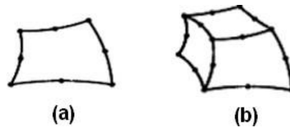
Figura 33 - Elementos utilizados no modelo (a) Casca de 8 nós (b) Sólido 3D de 20 nós.
