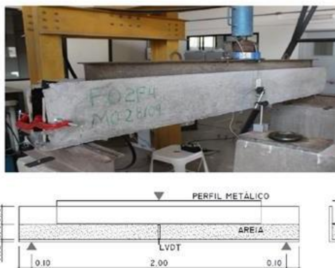
Figura 5 - Ensaio de flexão com carga distribuída.
