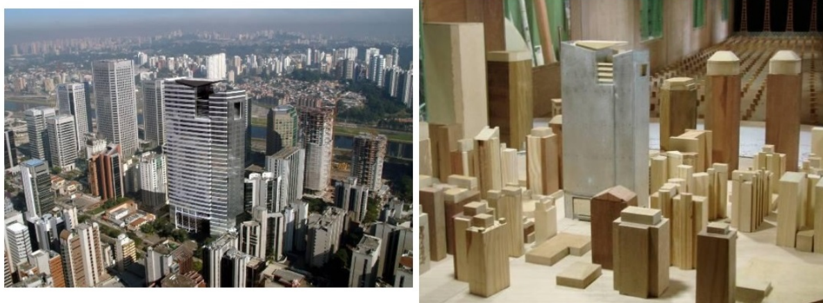
Figura 2.33 – Fotografia e respectivo modelo reduzido de um edifício com vizinhança. Fonte: Nunez, Loredo-Souza e Rocha (2012)
