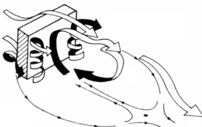
Figura 2.3 – Esteira de uma edificação rombuda. Fonte: Cook (1985)
