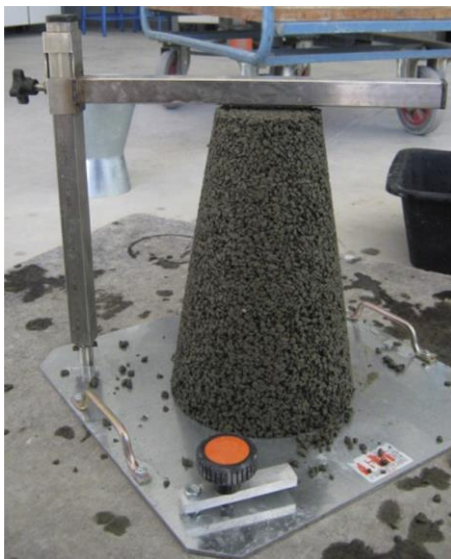
Figura 9: Realização do ensaio de abatimento em concreto permeável (Fonte: NGUYEN et al. 2014)
