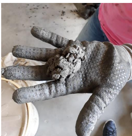
Figura 13: Avaliação tátil visual da mistura de concreto permeável
