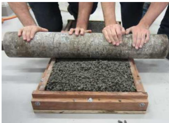
Figura 8: Compactação com rolo de aço (Fonte: LAMB, 2014)
